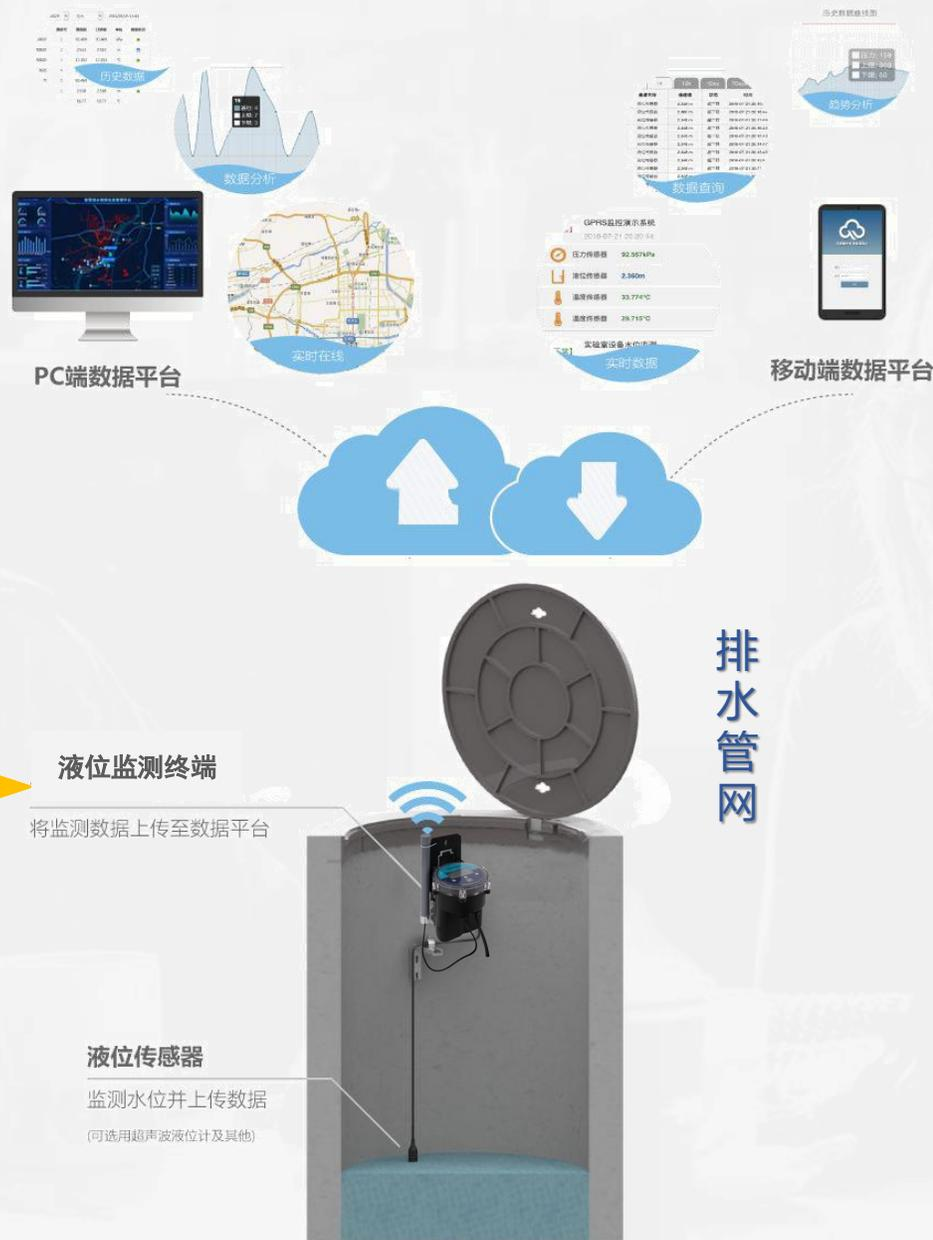
通过在管道设置泥沙厚度监测仪，将数据实时采集至智慧排水管网信息管理平台，以使工作人员在任何时候能清楚地掌握排污管道，污水管道，城市地下水管道的污泥量，及时有效地执行排泥操作，避免因积泥太多造成排泥管口堵塞。
