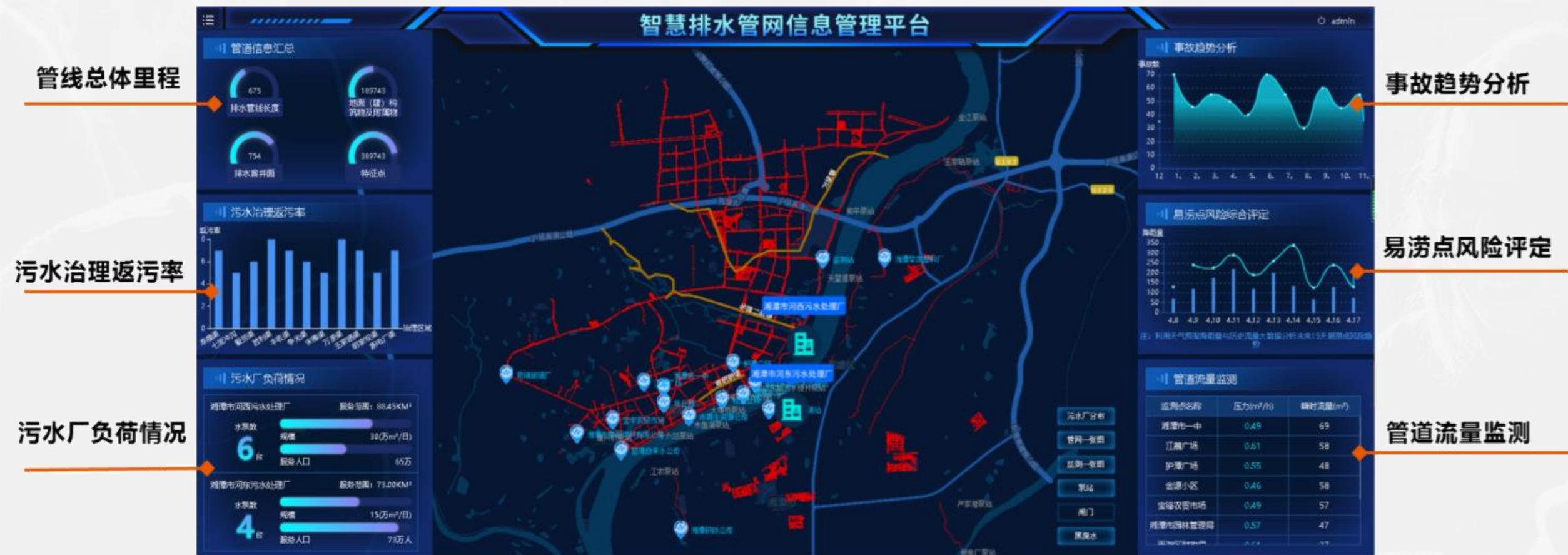
通过“一张图”展示管网设施数据、监测数据等，包括实时监测数据、运行状况、风险提示等，方便管理部门快速、精确处理。
