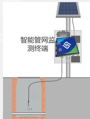
在带压力的排水管段，设置压力监测点，越限报警，便于及时发现管道破损和污水泄漏。
