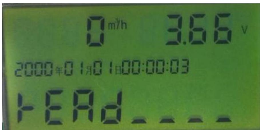
第 11 个页面：显示上报数据状态、电池电压、顺时流量、时间
