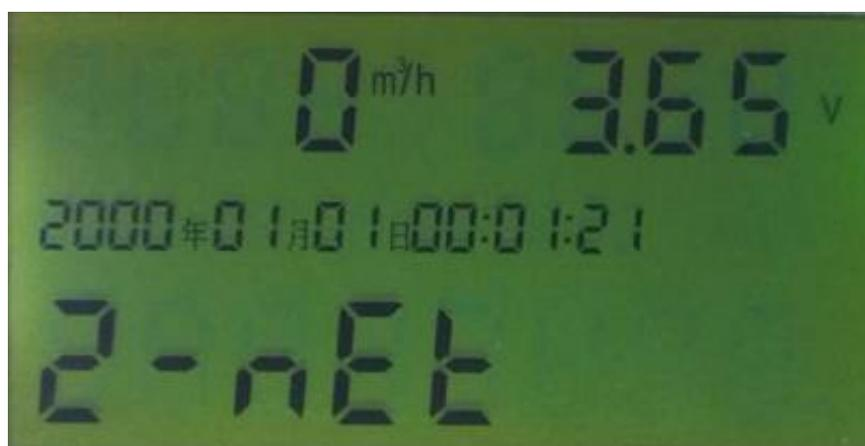
第 14 个页面：显示 GPRS 附着、电池电压、顺时流量、时间
