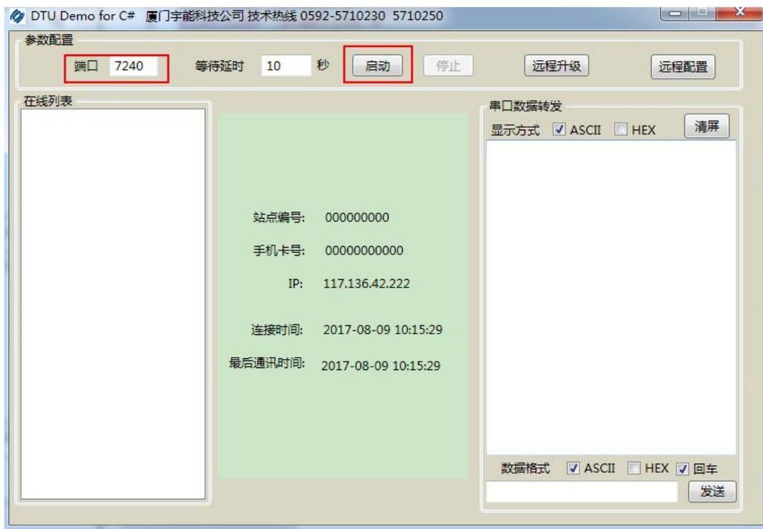
3、启动 GPRS 模块【手动触发上报】，连接成功后，升级工具会出现如下图红色区域；液晶屏显示内容为 6-TCP
