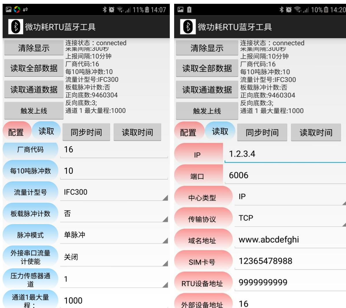
注：请注意所有参数按钮都显示为红色的时候为参数配置状态，点击参数按钮将对终端进行配置，请确保已正确输入配置数据，避免对终端进行错误的配置，导致终端工作异常。
