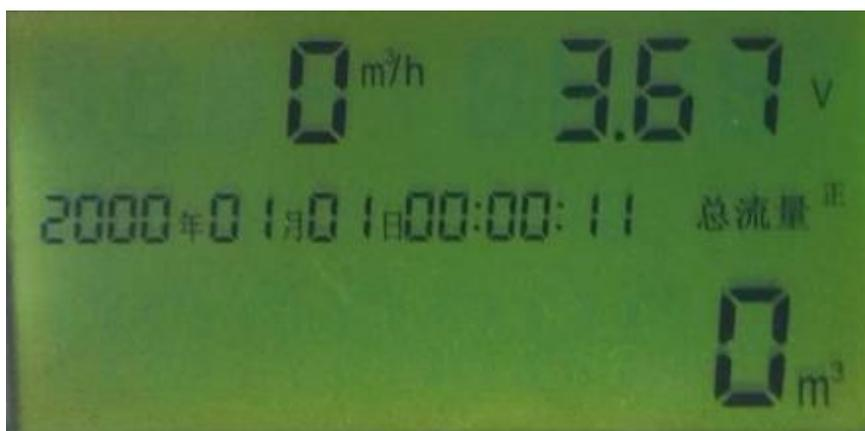
第 2 个页面：显示反向累计流量、瞬时流量、管网压力、时间
