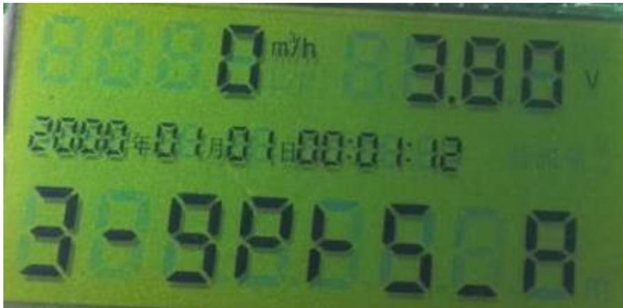
第 15 个页面：显示 GPRS 拨号、电池电压、顺时流量、时间
