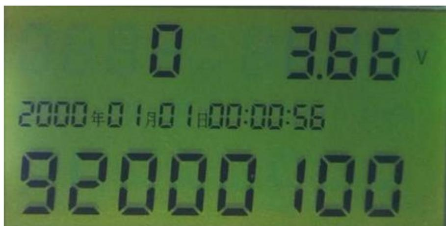
第 10 个页面：显示读取数据状态、电池电压、顺时流量、时间
