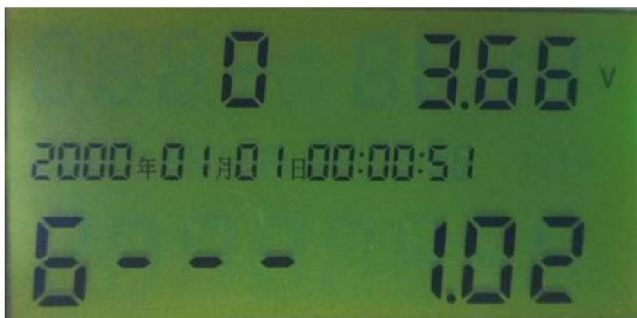
第 9 个页面：显示设备地址(显示后 8 位)、电池电压、信号值、时间
