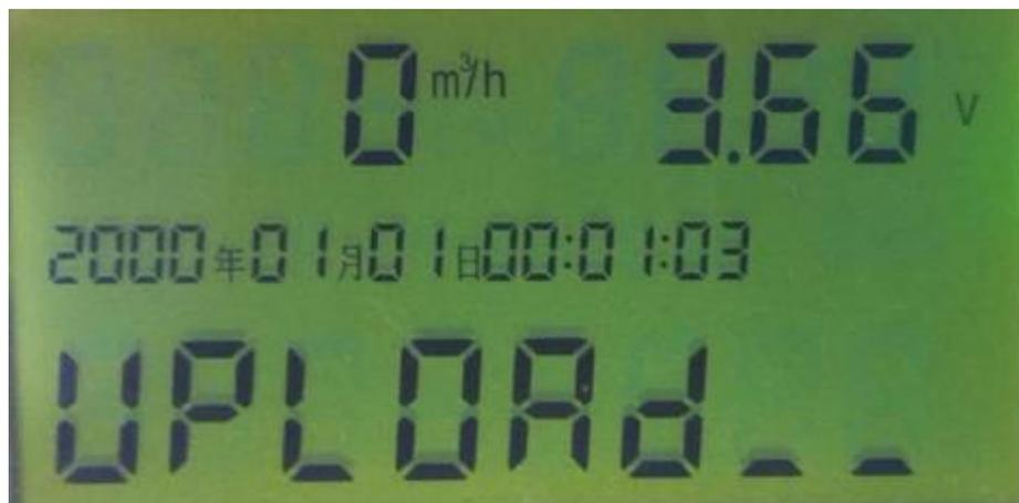
第 12 个页面：显示 SIM 卡准备、电池电压、顺时流量、时间
