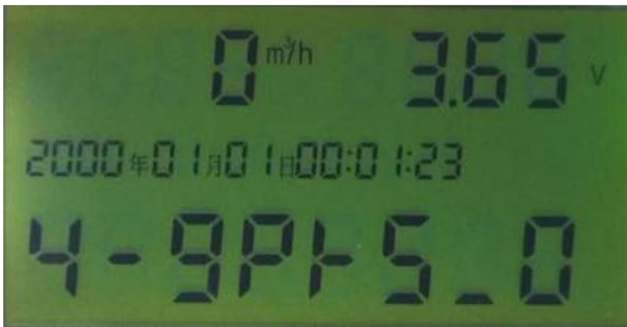
第 16 个页面：显示 PPP 拨号、电池电压、顺时流量、时间
