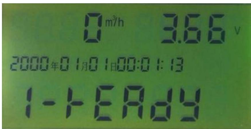
第 13 个页面：显示网络注册、电池电压、顺时流量、时间
