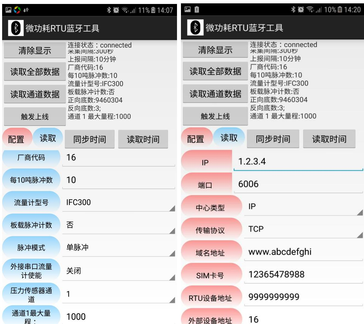
注：请注意所有参数按键都显示为红色的时候为参数配置状态，点击参数按键将对终端进行配置，请确保已正确输入配置数据，避免对终端进行错误的配置，导致终端工作异常。
